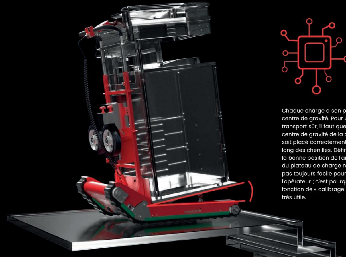
Chaque charge a son propre centre de gravité. Pour un transport sûr, il faut que le centre de gravité de la charge soit placé correctement le long des chenilles. Définir la bonne position de l'angle du plateau de charge n'est pas toujours facile pour l'opérateur ; c'est pourquoi la fonction de « calibrage » est très utile.
